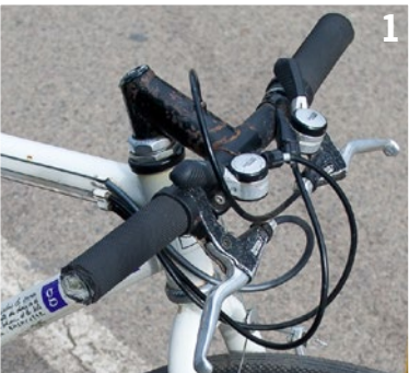
1. Le guidon très particulier de l'Emery Spécial limbo: un guidon ultra étroit et une potence inversée maison
