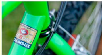
3. l'Inexternal welding : le raccord de brasure est effectué à l'intérieur des tubes : la soudure est invisible
