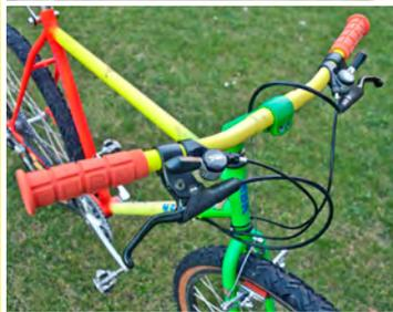
2. Un cintre au galbe prononcé, équipé des leviers XT et des commandes sur le guidon les fameux "Thumbshifter" très fonctionnels !
