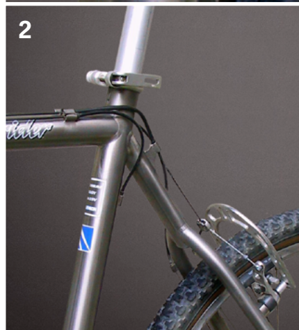
2. Un wishbone et un arceau rigidifient l'arrière du Cadre du Decathlon dont la souplesse fut la cause principale de son manque de fiabilité.
